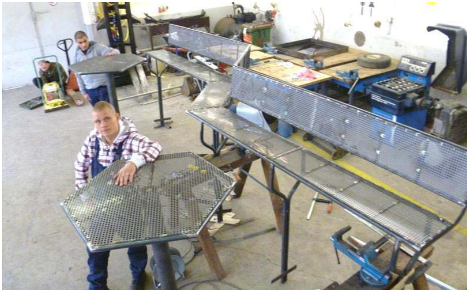
Abb. 14: Gemeinsame Kontrolle vor dem Verzinken und Einbrennlackieren
