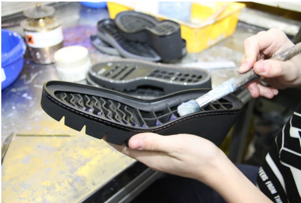
Abbildung 5: Vorbereiten einer Sohle (Gabor Shoes)
