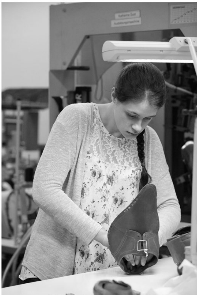
Abbildung 7: Hinterkappen einlegen (Lloyd Shoes GmbH)
