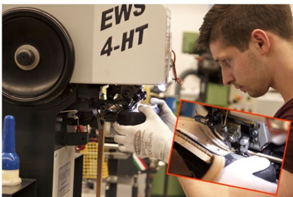
Abbildung 1: Bodenmontage (Lloyd Shoes GmbH)
