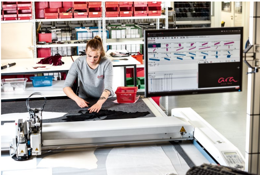
Abbildung 3: Zuschneiden des ausgelegten Leders (ara Shoes AG)
