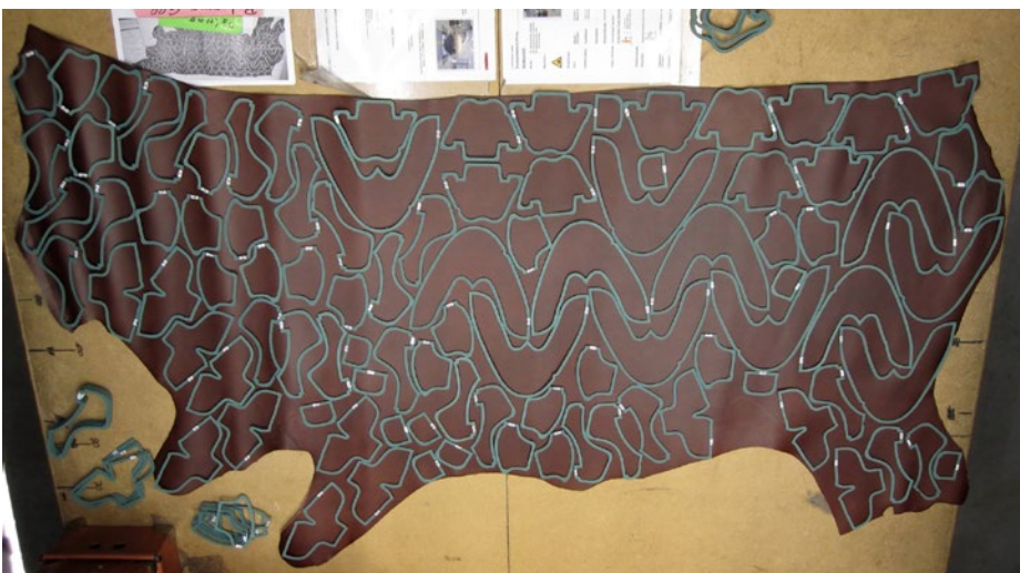
Abbildung 13: Beispiel ausgelegte Oberlederschablonen einer halben Haut (Lloyd Shoes GmbH)
