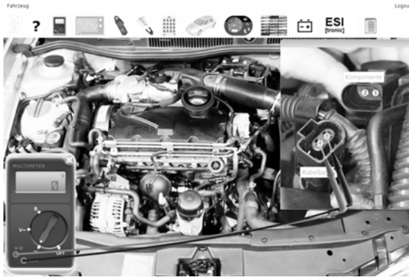
Abbildung 1: Screenshot aus der Kfz-Computersimulation, Spannungsmessung an der Steckverbindung des Ladedruckmagnetventils kabelbaumseitig zum Motorsteuergerät (eigene Darstellung).
