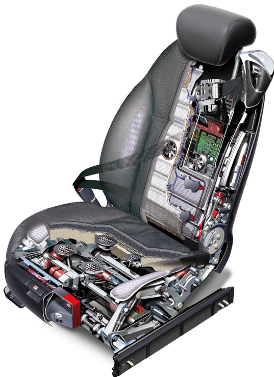
Abbildung 10: Schnittmodell eines Fahrzeugsitzes (Quelle: Mercedes Benz)
