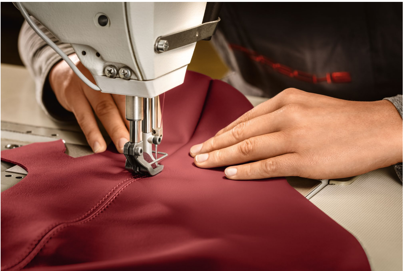
Abbildung 9: Nähen eines Sitzbezuges (Quelle: Porsche AG)
