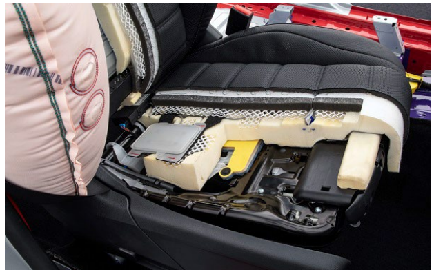
Abbildung 3: Beifahrersitz mit Sitzsensorik zur Deaktivierung des Airbags (Quelle: Mercedes Benz)
